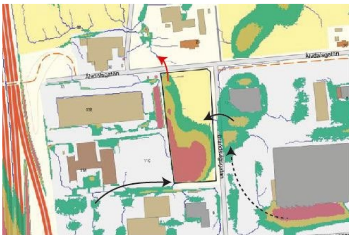
Figur 8: Översvämningsutbredning och vattendjup vid 68 mm. Gröna fält visar vattendjup upp till 20 cm, gula fält 20 – 50 cm och röda fält vattendjup över 50 cm. Svarta pilar markerar avrinningsriktning och streckade svart pil visar avrinningsriktning vid större regnhändelser. Röd pil visar avrinningsriktning då lågpunkten inom planområdet är fylld.
