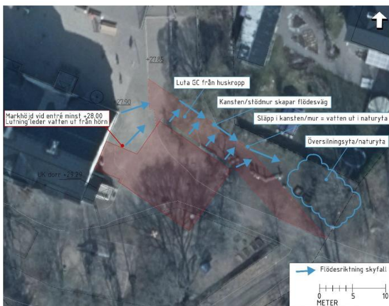
Figur 24. Utbredning av planerad tillbyggnad och ny vägdragning markerat i rött tillsammans med förslag på hur höjdsättning och lutning av mark (Civilscon 2024).
