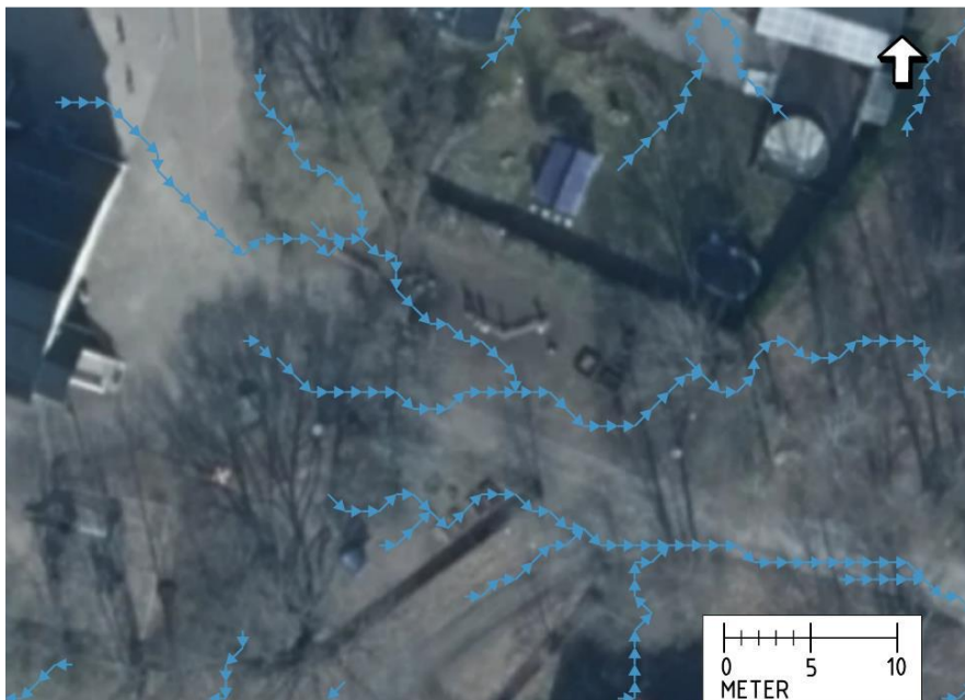
Figur 23. Inzoomat område på östra sidan av planområdet där ny tillbyggnad är planerad, med projicering av befintliga skyfallsvägar via Scalgo. Skyfallsvägarna leds idag bort från byggnader och vidare via grönområde i stället för in på norrliggande fastighet. (Civilscon 2024)
