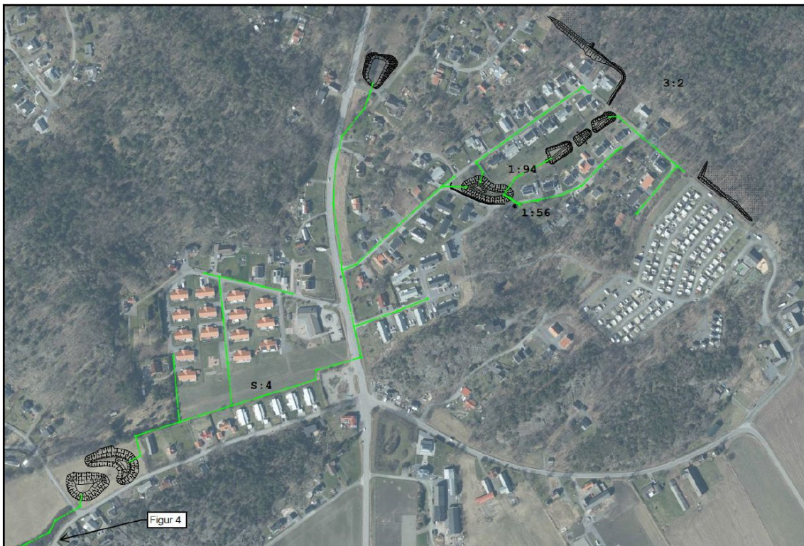
Lösningförslag för dagvattnet med dammar, diken och ledningar.
