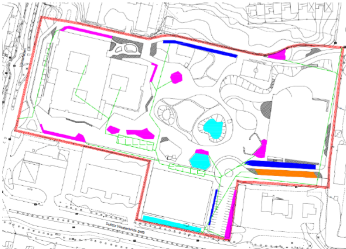
Figur 10. Kartan visar fördörjningsförslag inom det rödmarkerade planområdet. Ytor där det föreslås fördörjning i växtbäddar/biofilter är magentamarkerade. Ytor där skelettjord föreslås för fördörjning är mörkblåmarkerade. En makadamfördörjning under gräsarmering är ritat i orange samt översvämningsytor i cyan. Föreslagna dagvattenledningar att koppla ihop fördörjningar och leda dagvatten till befintliga anslutningspunkter är grönmarkerade.
