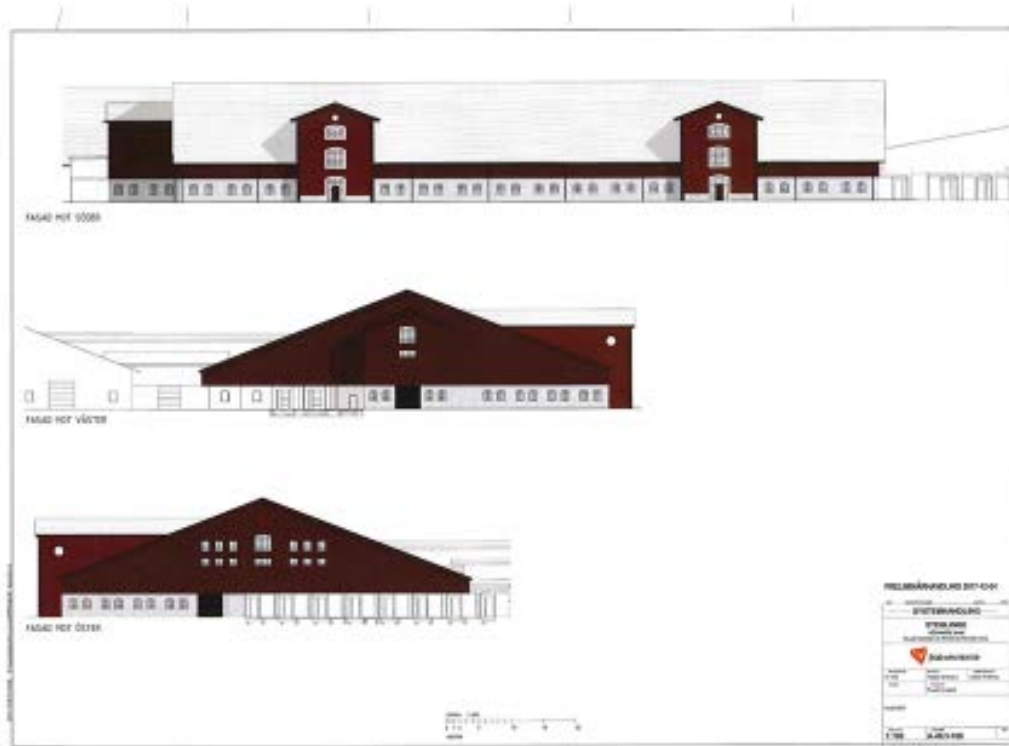
Bild 14: Fasadritning över den första planerade utbyggnaden i söder. Byggnaden är utformade som en större ekonomibyggnad vilket bygger vidare på den befintliga gårdens lantliga stil. Byggnadens utstickande frontespiser i söder bryter upp byggnadens volym och markerar byggnadens entréer där även trapphus och hiss kommer att finnas.
