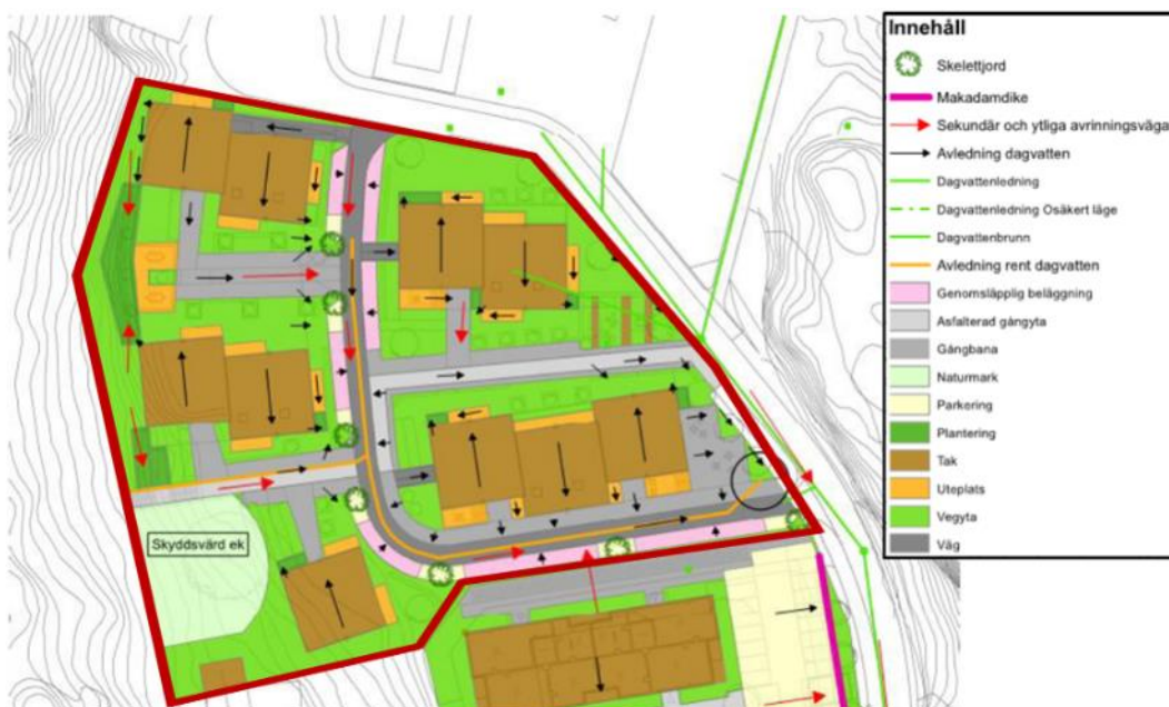
Bilden visar föreslagna anläggningar för rening och fördröjning av dagvatten.
