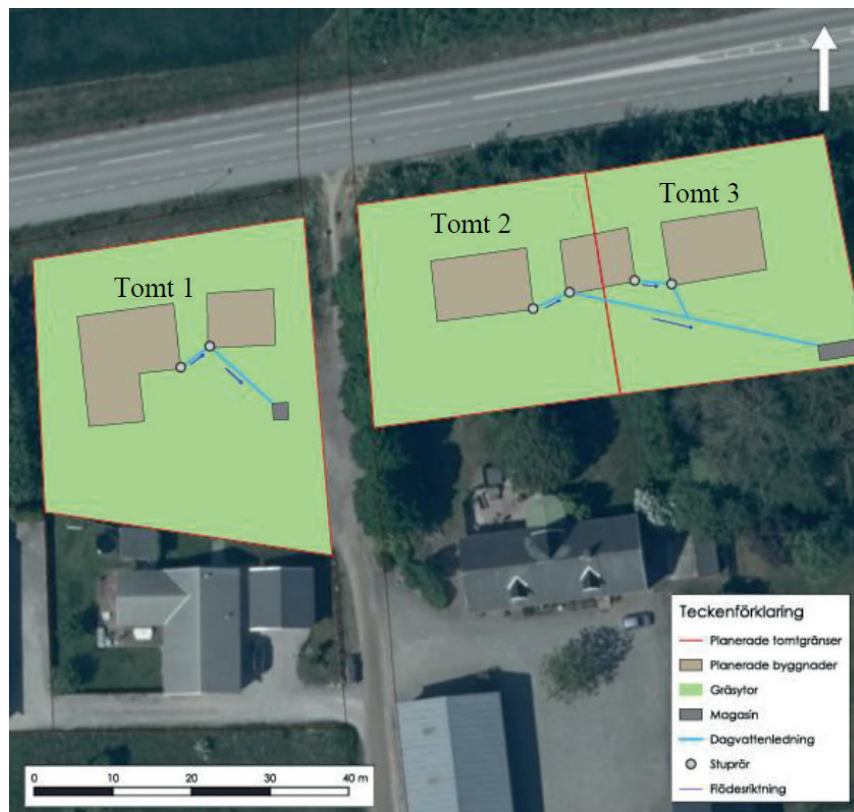
Illustration som visar en princip för dagvattenhantering för tomt 1 - 3.
