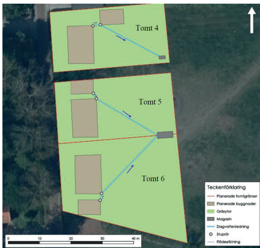
Illustration som visar en princip för dagvattenhantering för tomt 4 - 6.
