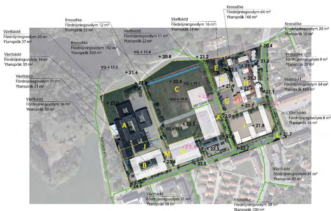
Figur 6: Föreslagen placering av dagvattenanläggningar och ytanspråk markerat i blått samt erforderlig fördröjningsvolym för respektive delområde inom utredningsområdet. Befintliga höjder i svart och framtida i rosa. Ortofoto: Lantmäteriet 2020-12-01.
