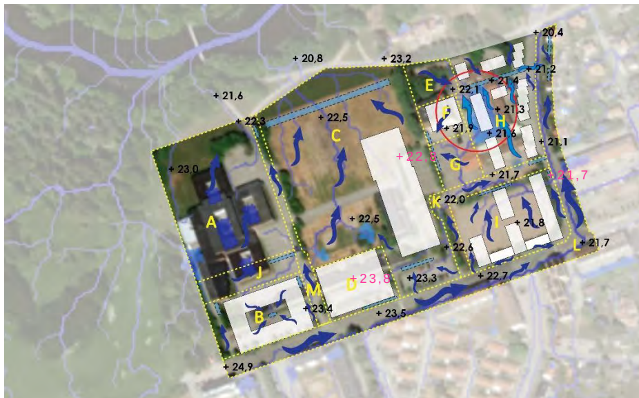
Figur 14. Önskvärda flödesvägar inom utredningsområdet vid extremregn. Befintliga höjder i svart och planerade i rosa. Betydande lågpunkt markerad med röd cirkel.
