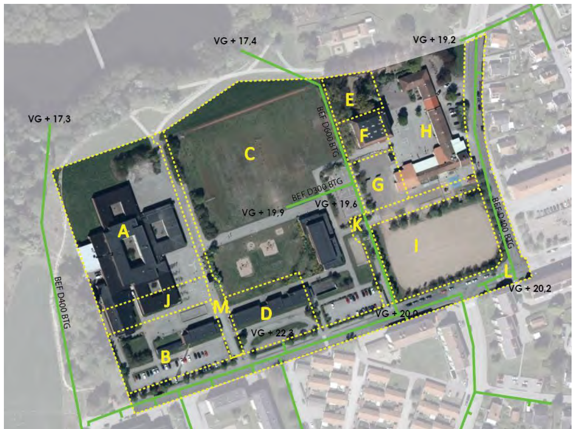
Figur 4: Befintliga dagvattenledningar inom och utanför utredningsområdet samt uppdelning av fastigheter av kvartersmarker och allmän platsmark efter exploatering med befintlig markanvändning. Ortofoto: Lantmäteriet 2020-12-01.
