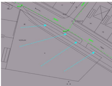
Dagvattnet från fastigheten rinner av idag till ett dagvattendike (bild från Sevab VA)
