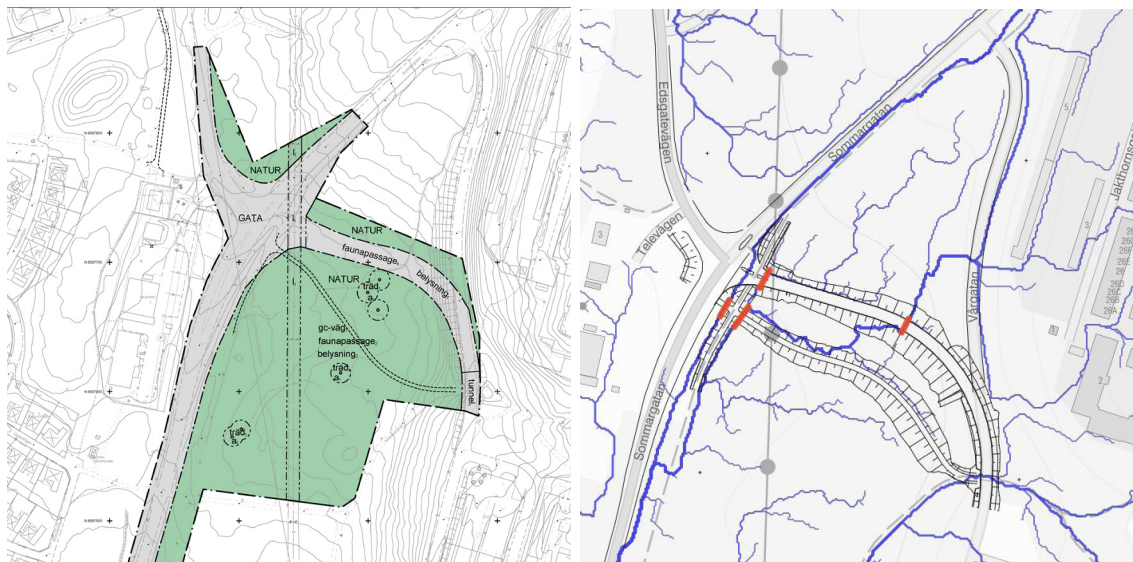
Bilden till vänster visar diket befintliga läge norr om den nya gatan. Bilden till höger visar skyfallsstråket och de planerade trummorna för vattnet (röda markeringar).
