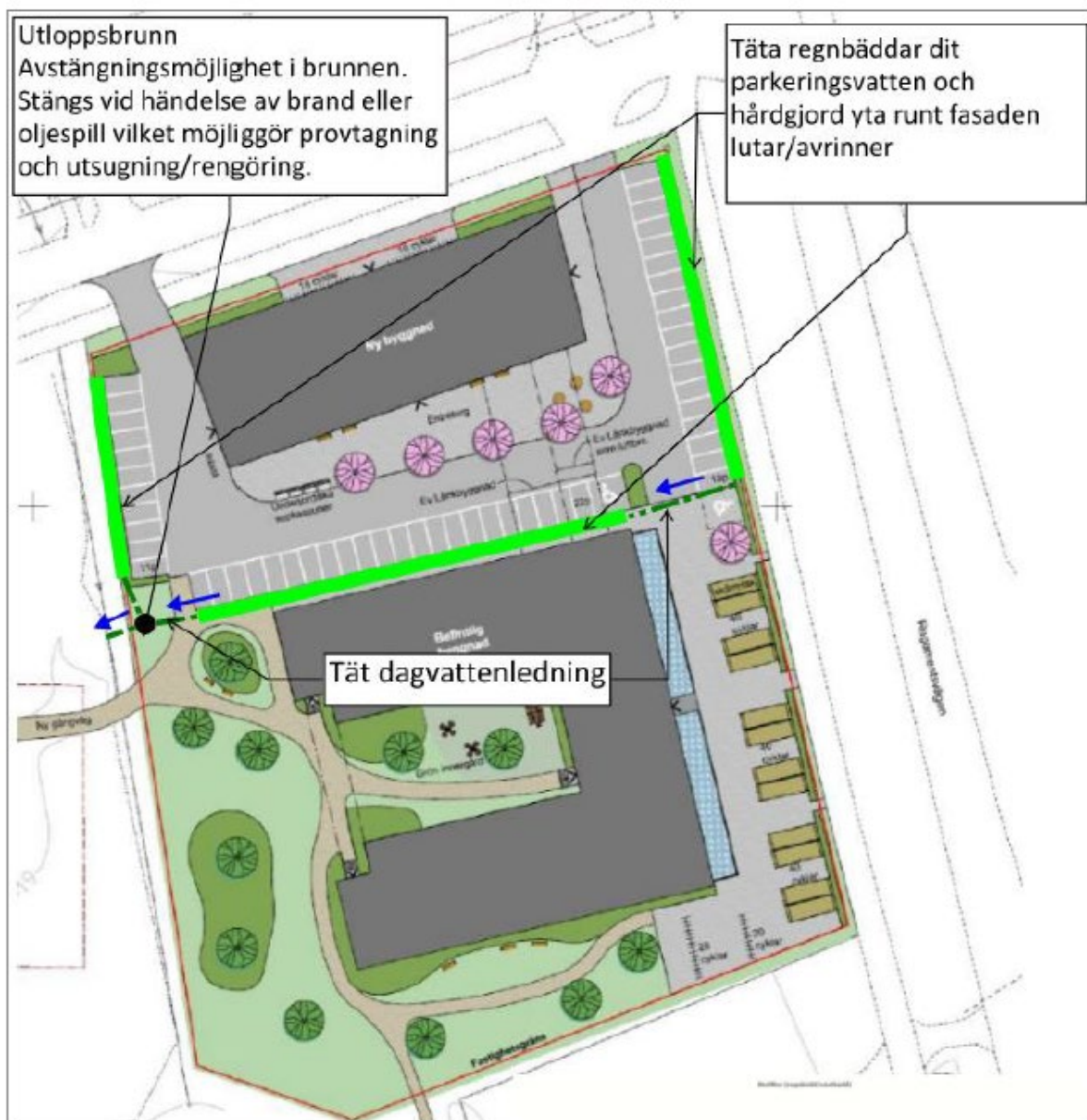
Figur 8. Förslag på dagvattenhantering inom fastigheten (Bjerking, 2024)
