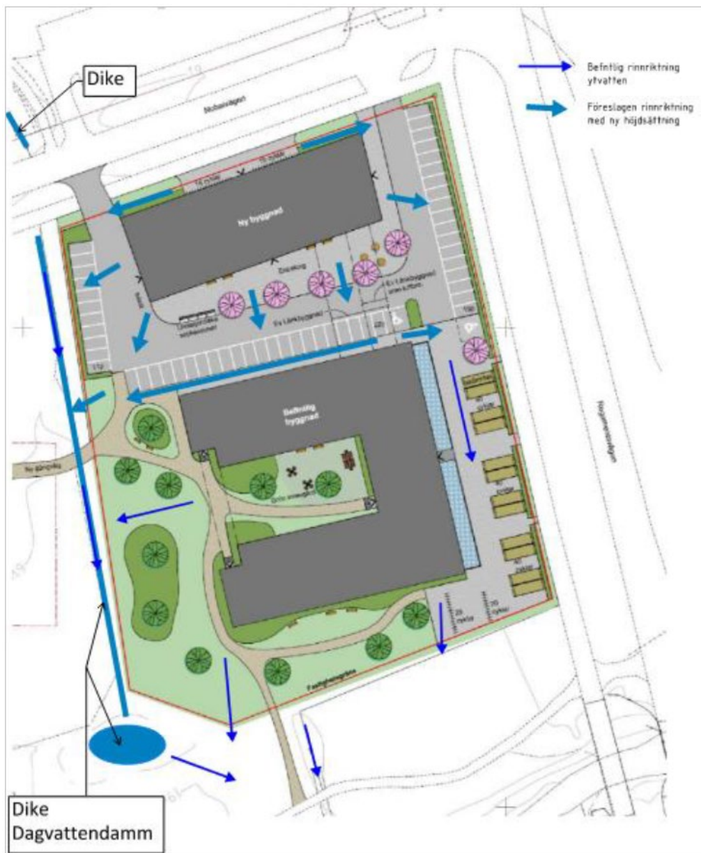
Figur 11. Befintlig och föreslagen rinnriktning vid 100-årsregn (Bjerking, 2024)
