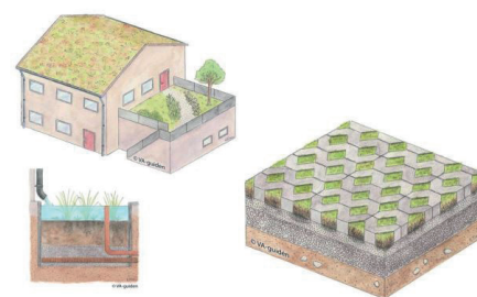
Exempel på lokalt omhändertagande av dagvatten på kvartersmark, från dagvattenutredningen (bilaga H) sidan 33.
