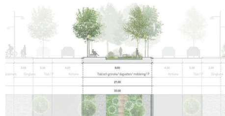
Principsektion genom parkgatan (Vetenskaps-gatan) med den centrala parkdelen markerad i vilken den största delen av dagvattnet från allmän plats kan fördröjas och renas. Den nedsänkta parkdelen medger en öppen fördröjning ( h = \text{ca } 0,15\text{m} ) varifrån vattnet kan infiltrera ned i en växtbädd ( h = \text{ca } 0,7\text{m} ). Totalt inom stadsdelen bedöms dessa parkzoner kunna ta emot ca 1750 m 3 av dagvattnet från de allmänna platserna.
