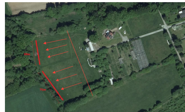
Illustrationen visar ett dagvattenutredningens förslag på placering av diken. Illustration: Dagvattenutredningen.
