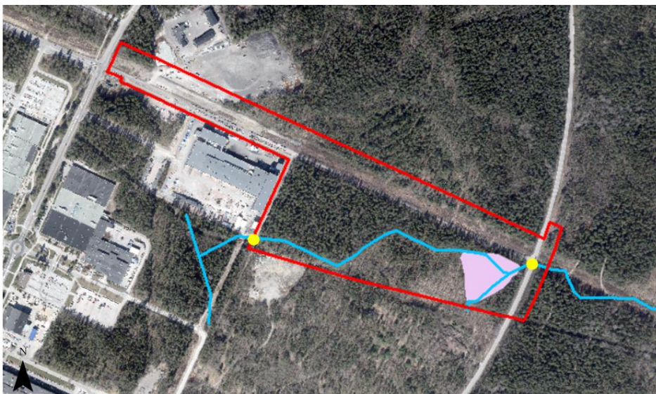
Figur 6. Befintligt dike (blå linje), placeringar av trummor (gula markeringar) samt utbredning av sumpskogen (rosa område).
