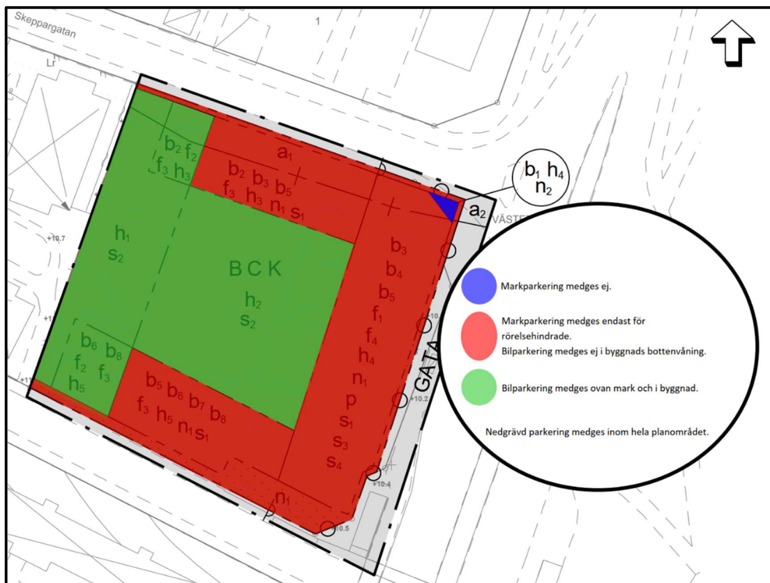
Figur 40. Förtydligande av hur bilparkering regleras i detaljplanen.
