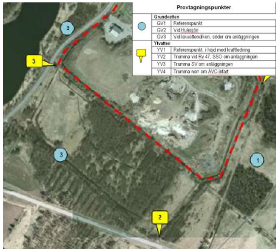
Figur 37 visar provpunkter för kontrollprogrammet gällande grundvatten/ytvatten för deponin.
