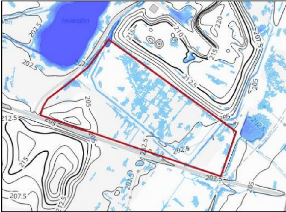
Figur 24 visar vattensamlingar vid ett stående 200-årsregn.
