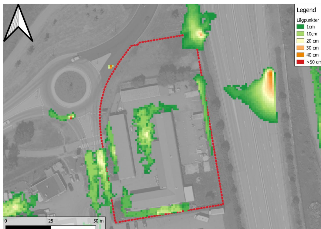
Figur 5 Lågpunktsanalys från dagvattenutredning
