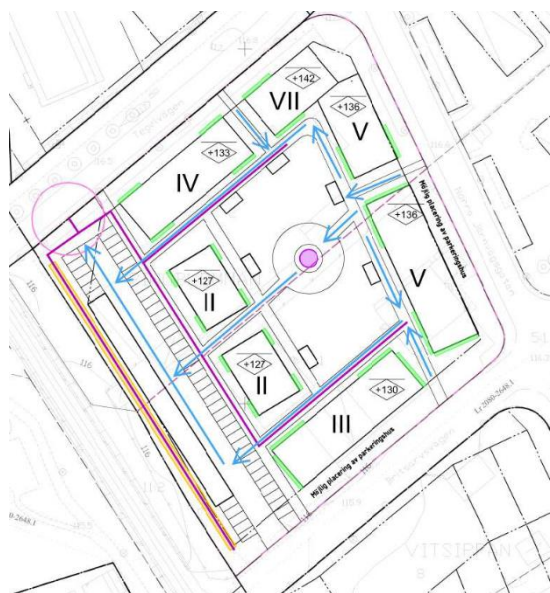
Illustration över möjlig systemlösning bestående av växtbäddar i grönt, skelettjord i lila samt infiltrationsstråk i gult. Önskad servispunkt från fastigheten inom rosa cirkel, möjlig ledningsdragning illustrerad i lila och marklutning illustrerad med blå pilar. Källa: WSP, 2023-06-13
