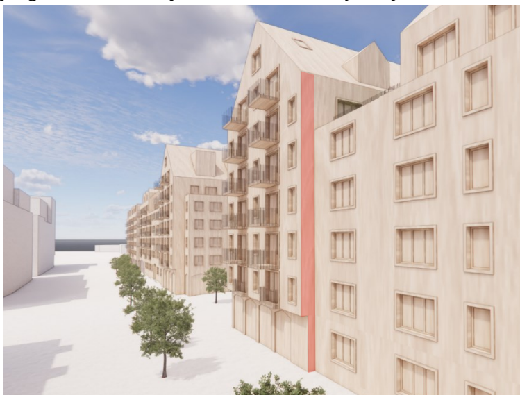
Illustration av hur de gavlar genom planbestämmelse b7 tillåts kraga ut från övrig fasad för att bryta en annars rak fasadlinje (röd markering). Från plan 2 är det möjligt för gavlarna att kraga ut till fastighetsgräns. (Stadstudio)
