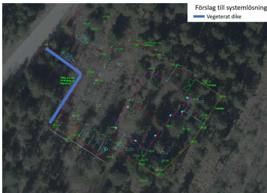
Föreslagen systemlösning med fördröjningsdike i väster (Sweco, 2020)
