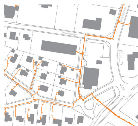
Befintligt ledningsnät för fjärrvärme
