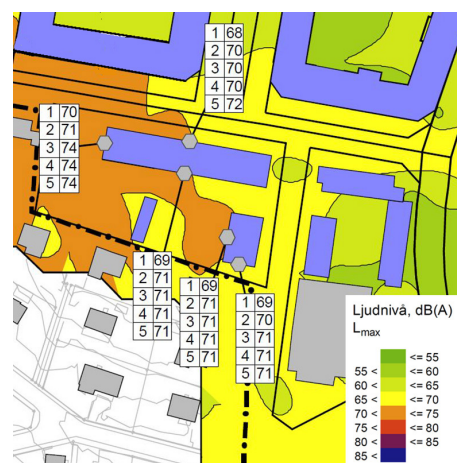
Maximal ljudnivå 2 meter ovan mark och punktberäkning vid fasad. Tågtrafik. Utsnitt ur bild över ljudutbredningen från Bullerutredning Mariesjö, 190305 (Bilaga F).
