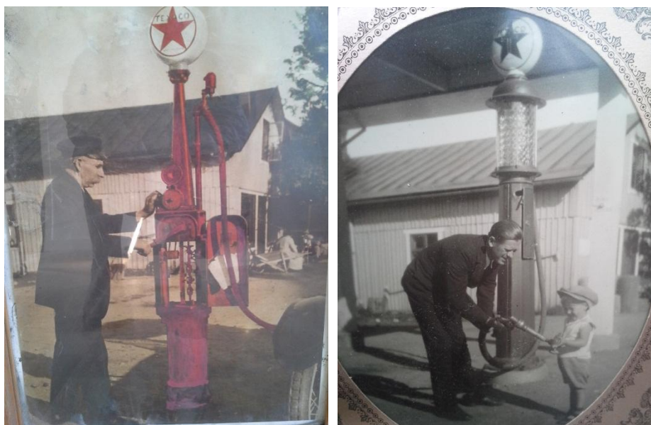
Figur 3 och 4. Bilder från Hjördis Brandquists fotoalbum. Bilderna är tagna från ungefär samma plats. Bilden till vänster visar en handdriven bensinpump av tidig modell och är troligen tagen i slutet av 1920-talet. Bilden till höger visar en sk Vici pump som även den drevs manuellt. Pumpen började tillverkas år 1927. Ett tak har byggts över pumpen/pumparna och man kan skymta en byggnad i vänster bildkant. Byggnaden i bakgrunden ligger strax öster om aktuell fastighet.
