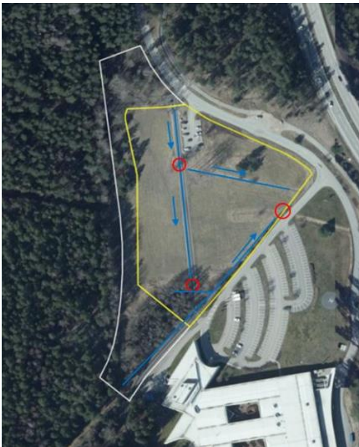
Bild 14, Befintligt avvattningsystem består av diken (blå linjer) och kulvertar (röda cirklar). Blå pilar visar flödesriktning. Vit linje visar plangräns och gul linje visar kvartersmark. Marken mellan gul och vit linje är allmän platsmark.
