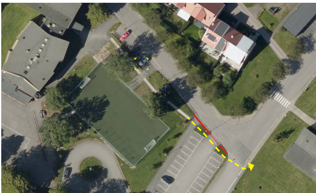
Förlängning staket (rött) och gångbana (gult).
