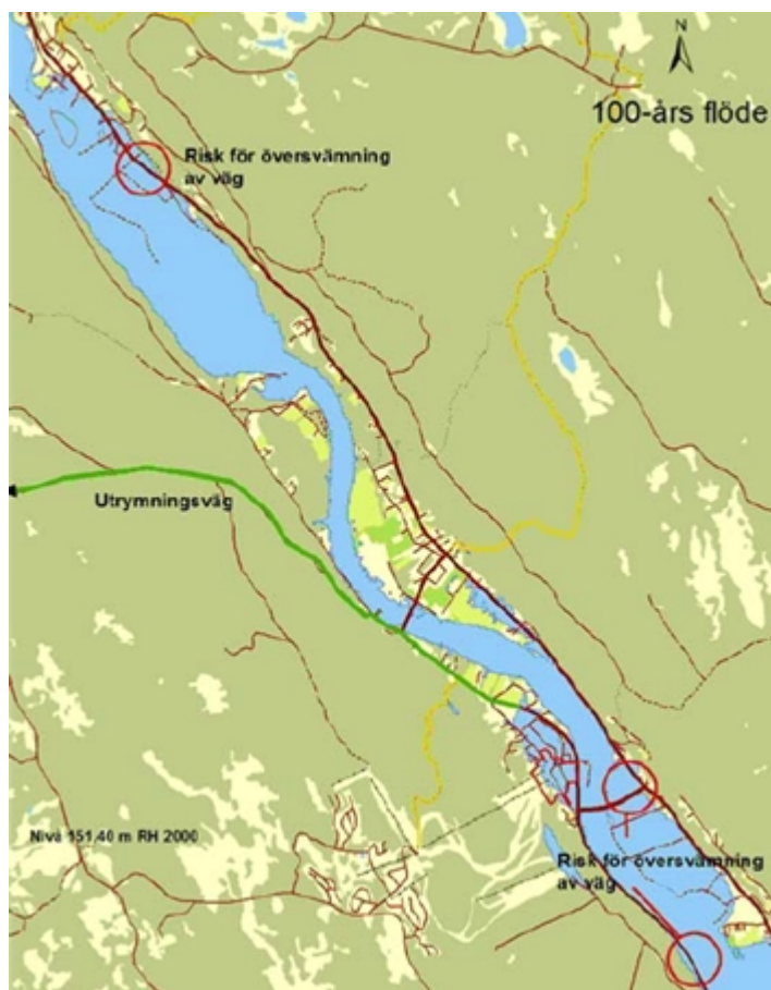
Bild 10: Kartmaterial från översvämningsutredningen. På bilden syns alternativa utrymningsvägar vid översvämning samt kritiska punkter för översvämning av vägar.
