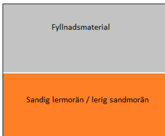
Figur 2: Principiell skiss över dimensionerande jordlagerföljd.
