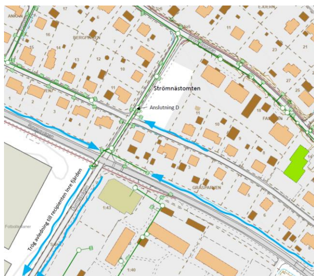
Figur 10. Illustration av flödesriktningar i diken
