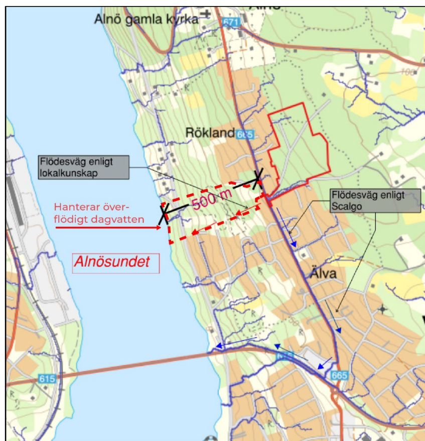
Figur 8: Markerad flödesväg till recipienten samt utrymme för fortsatt fördröjning. Källa: Afry
