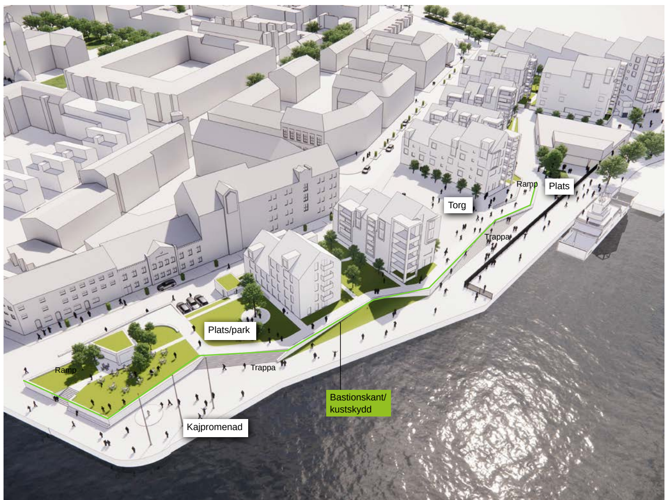
Huvuddragen i Skeppsbrokajens uppbyggnad som kustskydd integrerat med bostäder och offentliga ytor.
