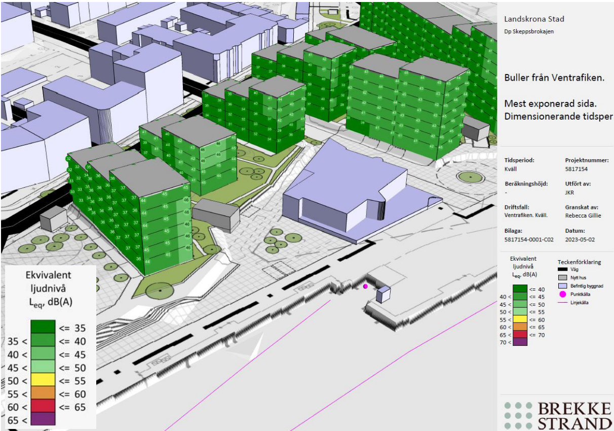
Buller från Ventrifiken. Mest exponerad sida under dimensionerande tidsperiod. Samtliga fasader klarar bullervärdena. Bild: Brekke-Strand.
