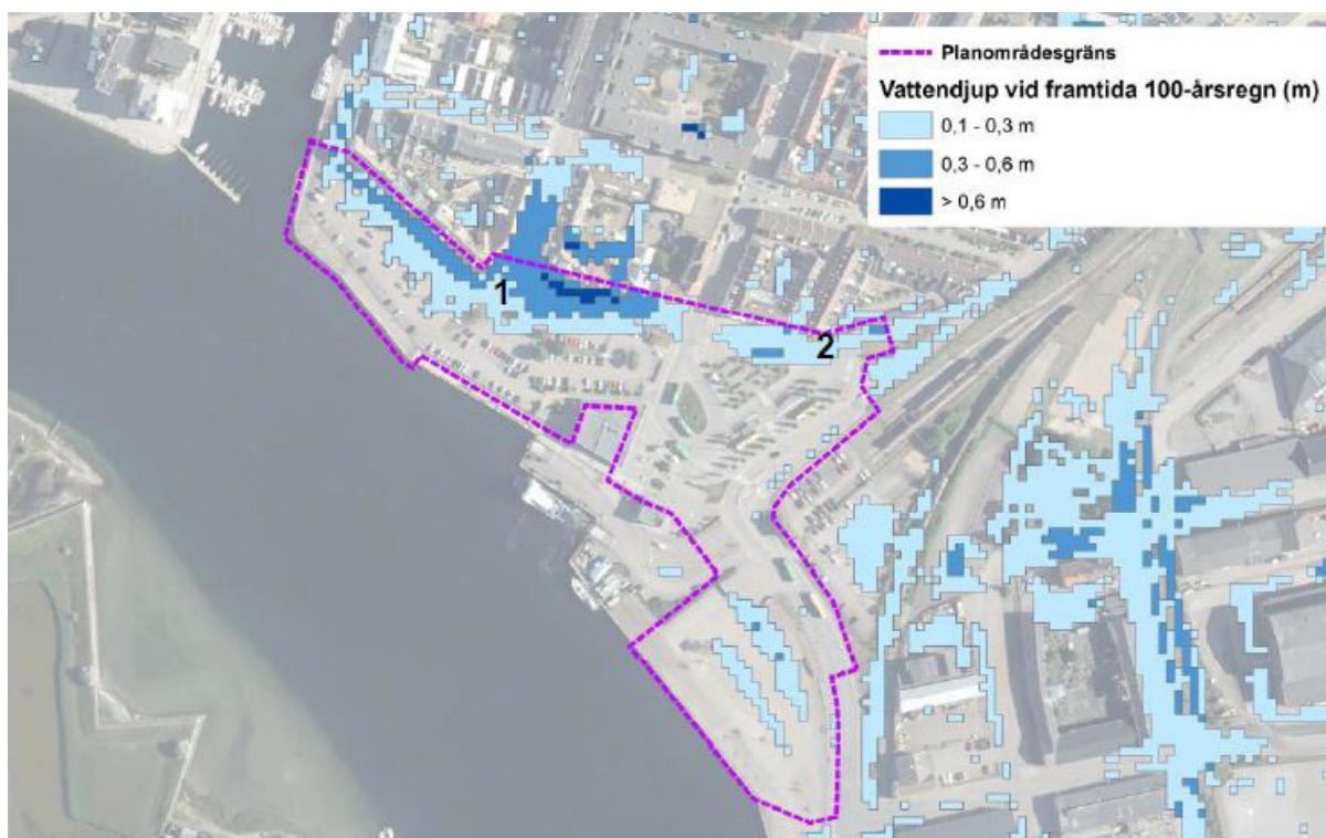
Resultat från Landskrona stads skyfallsmodell. De två lågpunkterna inom planområdet är markerade med siffror 1 och 2. Bild: Sweco
