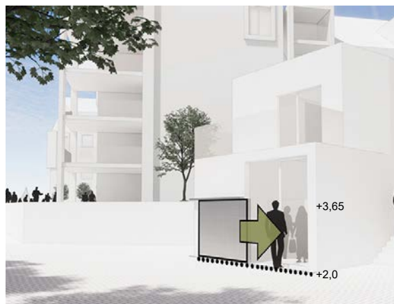
Kajpromenaden. Exempel på översvämningssäker port vid högvatten för de lokaler som ligger under nivån +3,65 meter.
