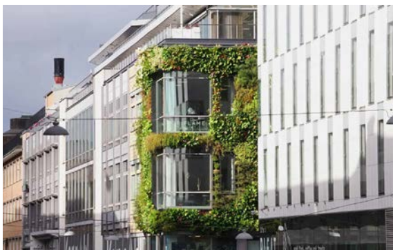
Växtväggar som exempel på ljudabsorberande fasadutformning
