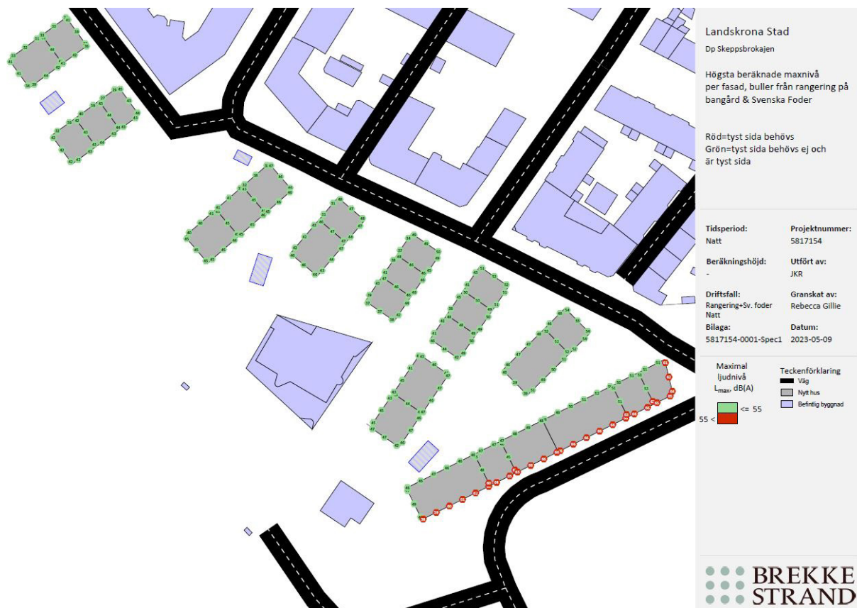
Bullernivåer i plan som visar vilka byggnader som behöver tyst sida. Maxnivåer nattetid. Bild: Brekke-Strand.
