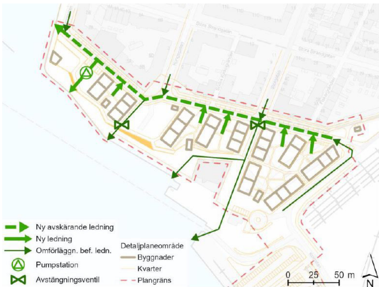
Dagvattenhantering. Ny huvudledning i Lilla Strandgatan samlar upp dagvatten från innergårdar och torg. Bild: Sweco
