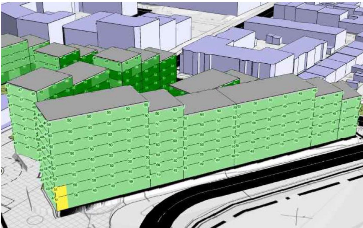
Läge där del av huskropp har överskridna värden med 1 decibel nattetid. I detta läge medges inte bostäder utan endast centrumverksamhet samt samlingslokaler för bostäder. Bild: Brekke-Strand.
