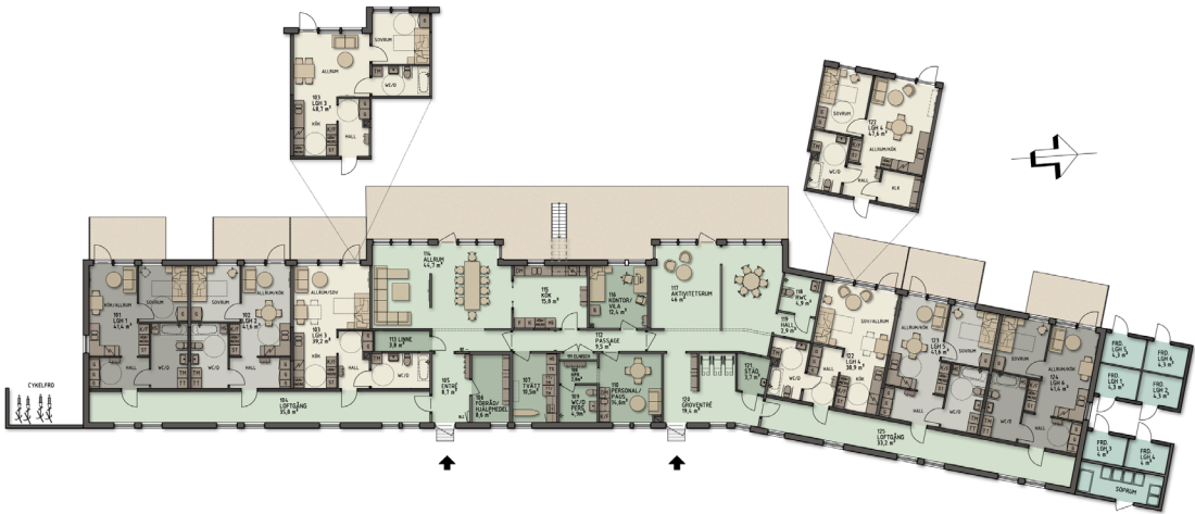
Skiss över invändig ombyggnation för att möjliggöra gruppboende på Ringvägen 3A och B
