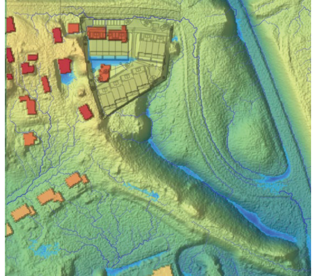
Modelleringar från tillhörande dagvattenutredning över ett skyfall (100-årsregn). I vänstra bilden syns dagens läge och i den högra syns den exploaterade detaljplanen.
