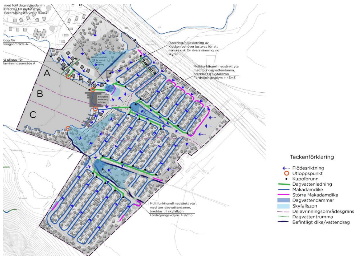
Figur 15. Principskiss över föreslagna dagvattenåtgärder (Ramböll, 2018).
