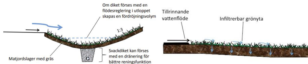
Figur 8 och 10 Exempel på svackdike och infiltrerbar grönyta, enligt Stockholm vatten och avfall, 2020
