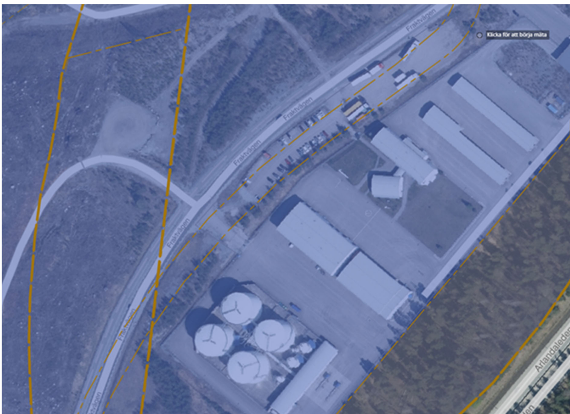
Bild 1 Befintliga gränser för lokalgatan visas med tunna orange linjer på ortofoto med vägens verkliga placering.
