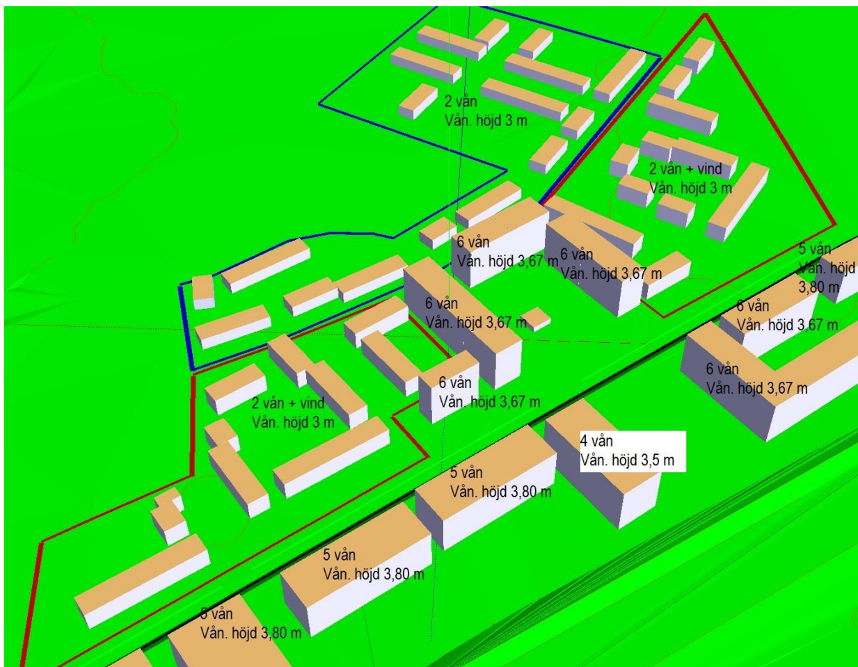
Figur 2. Antal våningar och våningshöjd för bullerberäkning.
