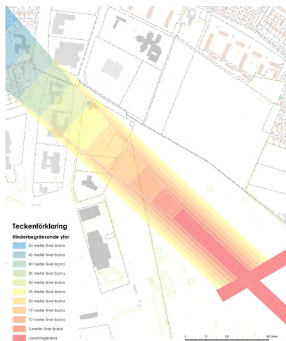
Figuren visar hur den hinderbegränsande ytan för flygtrafik i området förhåller sig till landningsbanan. För varje 100 meter vi förflyttar oss bort från landningsbanan ökar också den hinderbegränsande ytans höjd med 5 meter.
