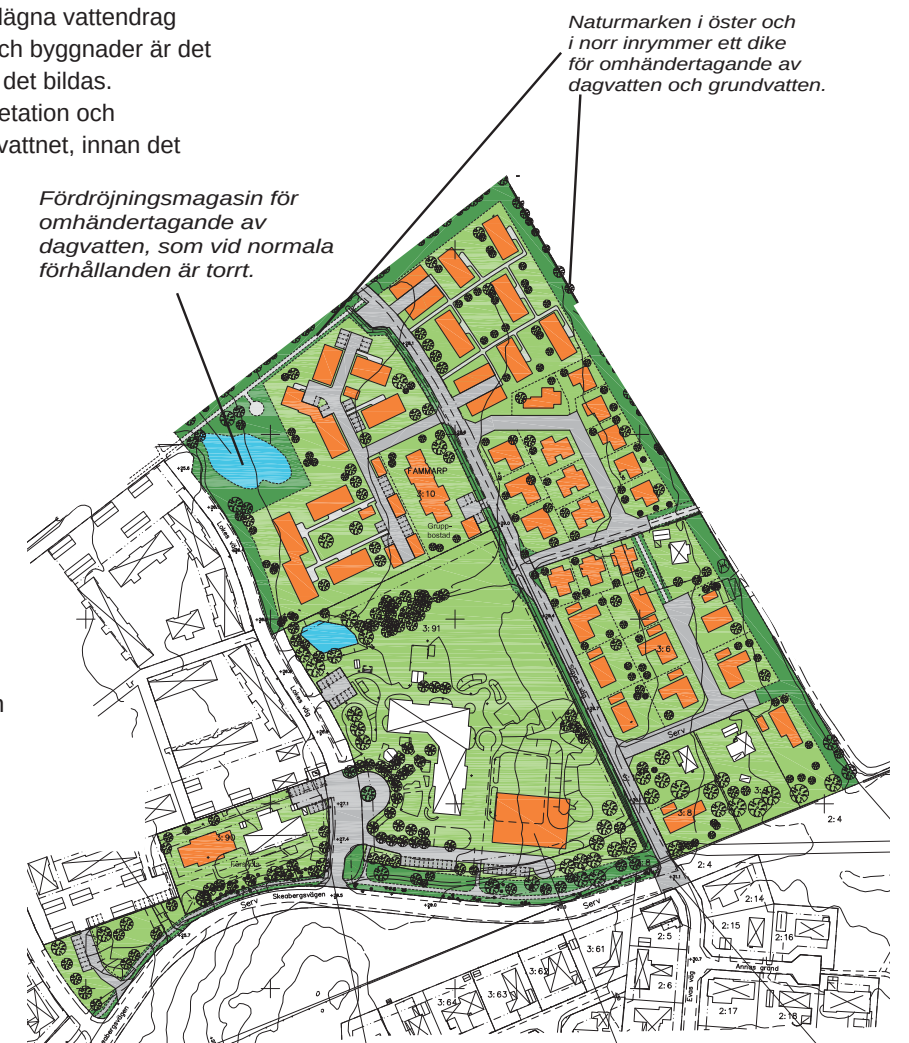
Dagvattnet inom Fammarp hanteras i system av dagvattensståk i grönytor och gatumark samt i fördröjningsmagasin.
