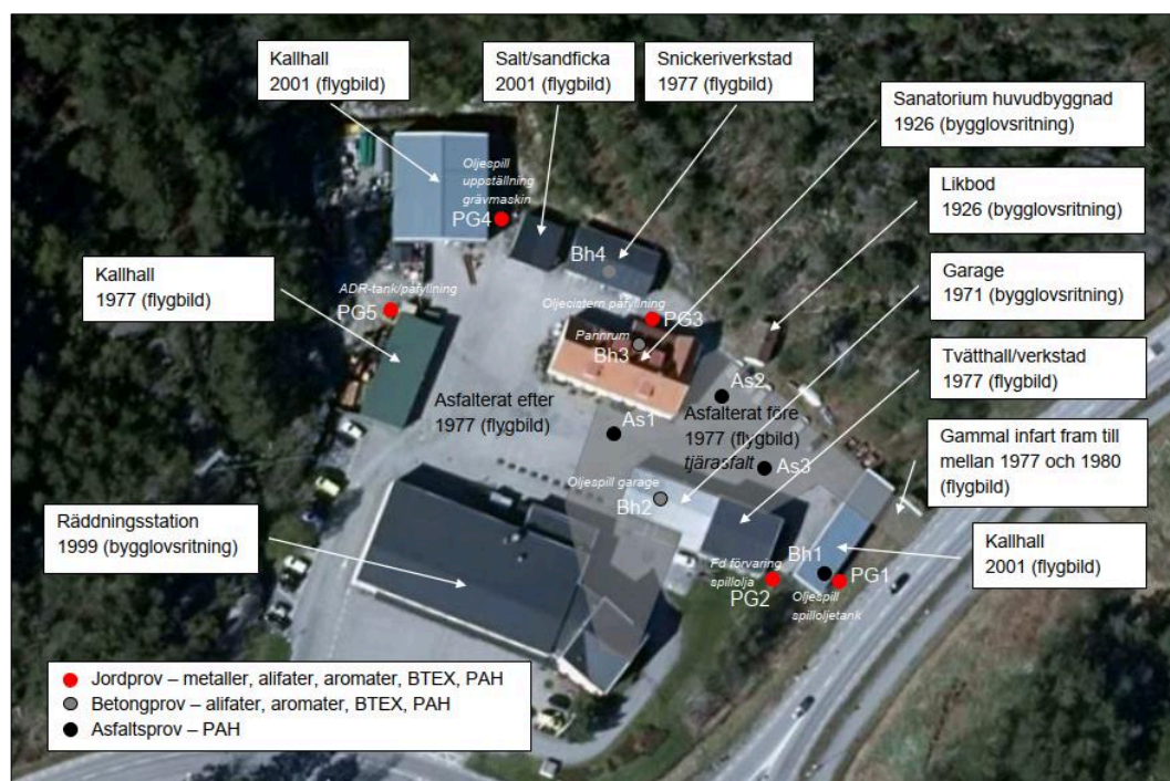
Figur 5. Provpunkter i jord (rött), asfalt (svart) och betong (grått).
