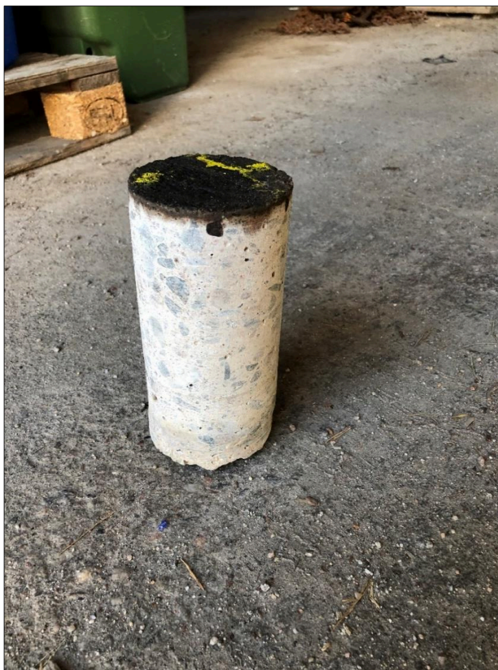
Figur 7. Betongkärna från Bh2 som ligger i garaget intill tvätthallen. Den svarta överytan utgörs av oljespill på golvet.
