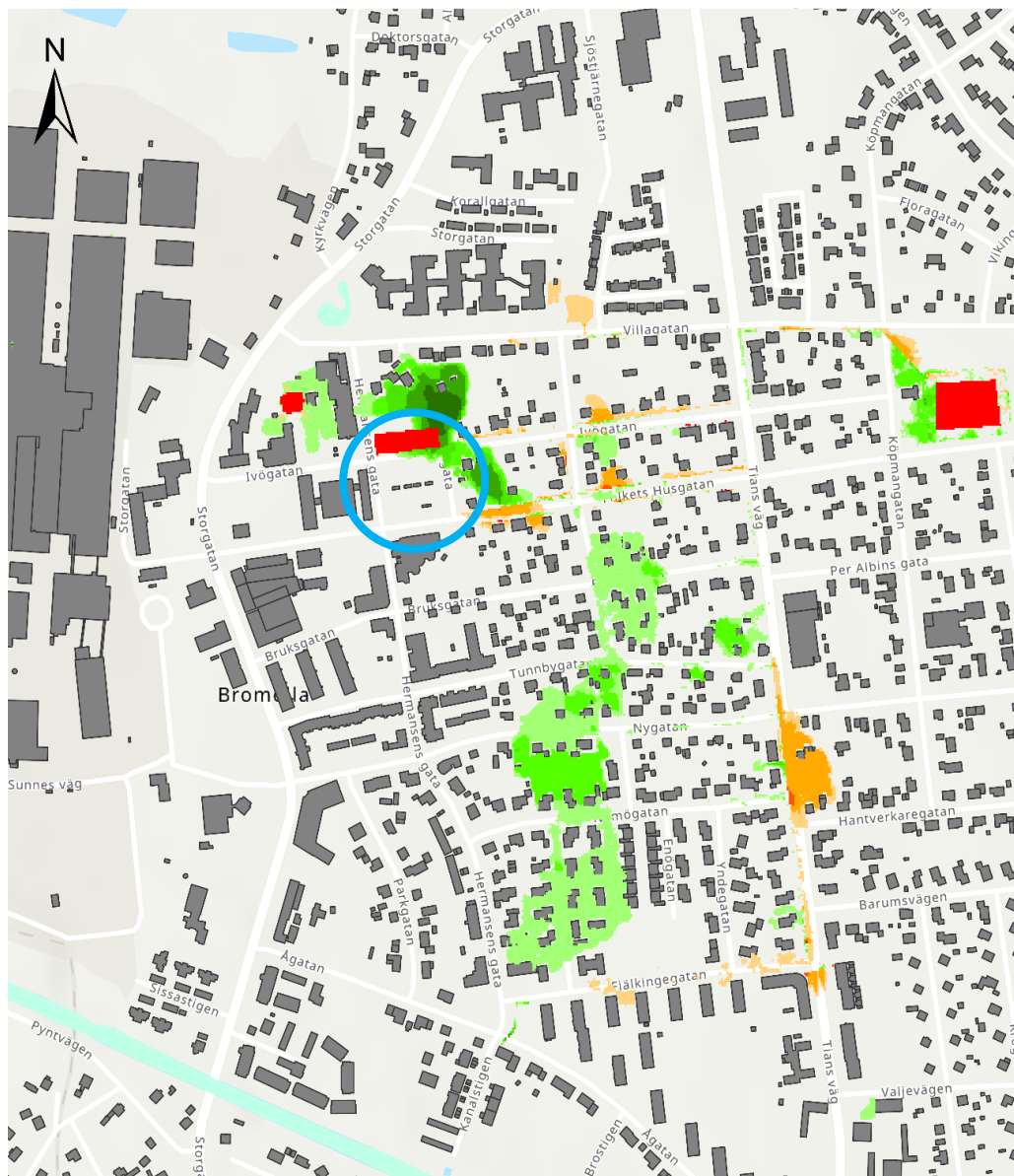
Figur 9. Förändring i maximala översvämningar vid 100-årsregn till följd av föreslagna skyfallsåtgärder i område väster om Tians väg (Tyréns, 2020). Längs med Tians väg, Ivögatan och Folkets Husgatan förvärras översvämningarna något enligt simulering, vilket beror på att modellen inte detaljerats fullt ut med kantsten och regnbäddar. Föreliggande utredning har syftat till att i stora drag kartlägga och simulera åtgärdsbehovet. Planområdet markerat i blått.
