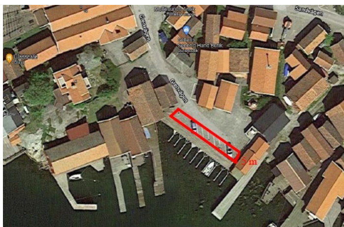
Figur 19 Område som visar på skyddszon (0 kPa lastrestriktion) bakom kajkonstruktion. Bild från COWIs utredning, 2021-10-21
