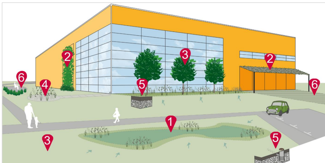
Figur 40. Förslag på hantering av de mindre regnen på kvartersmark: 1 = dagvattendamm, 2 = tak och väggar med växtlighet, 3 = planterade markytor och träd, 4 = växtbäddar, 5 = stenkista eller fördröjningsmagasin, 6 = genomsläpplig markbeläggning. Bild: Norrköpings kommun.
