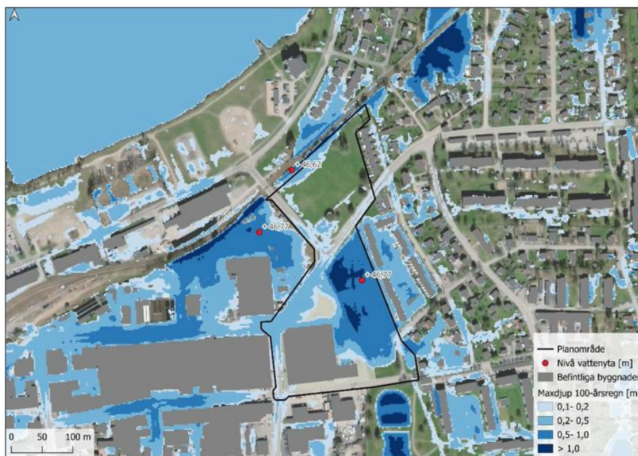
Figur 36 Befintlig översvämningssituation vid skyfall. Sweco 2024
