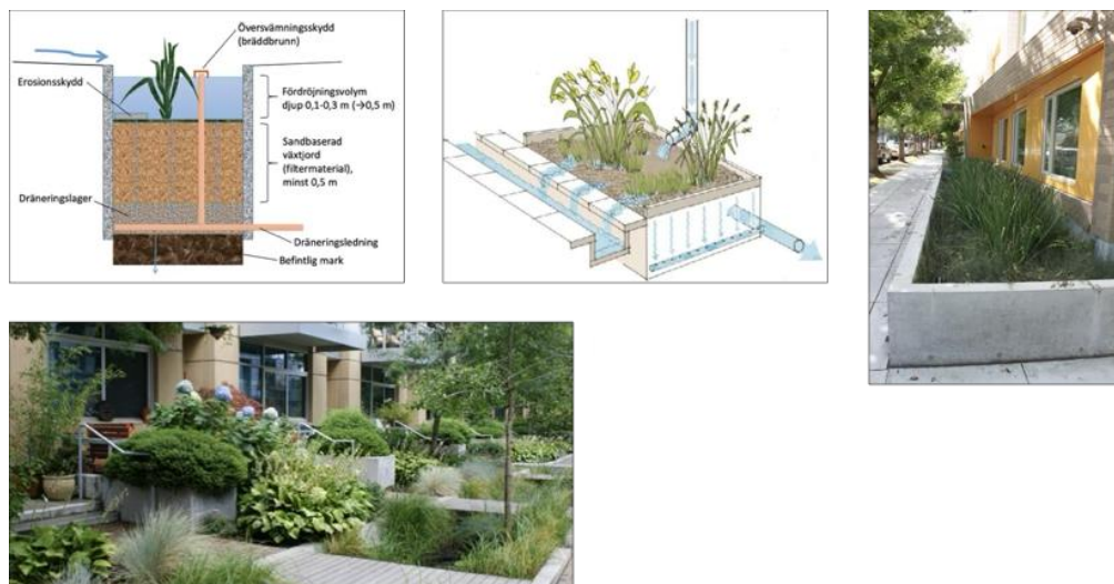
Figur 43 Principskisser på nedsänkt växtbädd med fördröjningsvolym. Illustration WRS och Tengbomgruppen samt exempel på växtbäddar i stadsmiljö.
