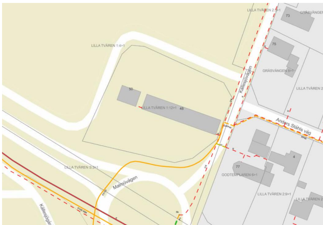
Situationsplan över kabelledningar enligt Skanova (2018)
