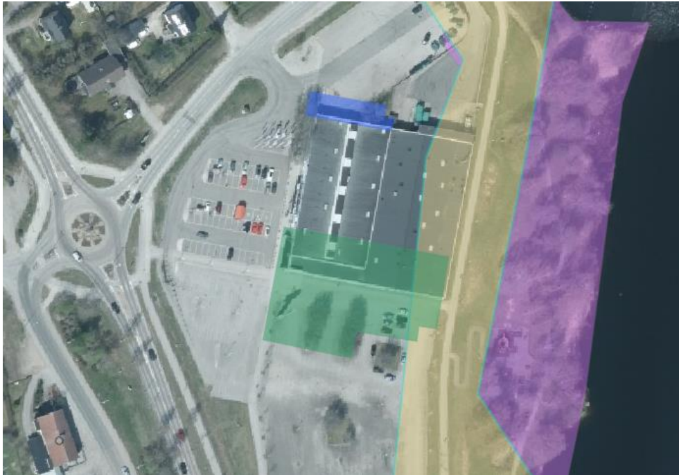
Figur 9. Gul och lila yta visar aktsamhetsområde för skred i finkornig jordart enligt kommunens kartmaterial. Blå yta visar planerad tillbyggnad norr om befintlig byggnad. Grön yta visar tillbyggnad söder om befintlig byggnad för vilken en geoteknisk utredning har genomförts.
