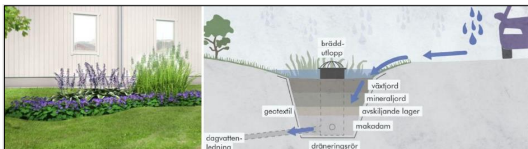
Figur 12. Illustration av nedsänkt växtbädd. Illustrationen är hämtad från dagvattenutredningen. (SWEKO, 2021).
