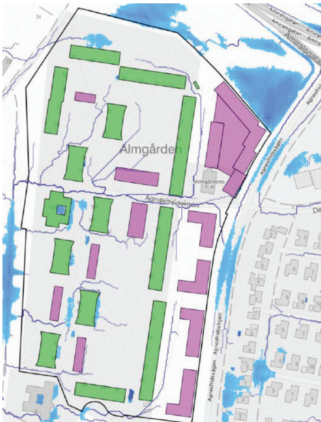
Figur 34. Skyfallsanalys i SCALGO LIVE för framtida förhållanden då ett regn som kalibrerats efter Malmö stads skyfallsresultat har simulerats. Befintliga byggnader är markerat i grönt, medan framtida byggnader är markerad i lila. Rinnvägar och stående volymer illustreras i blå. (Ramböll)
