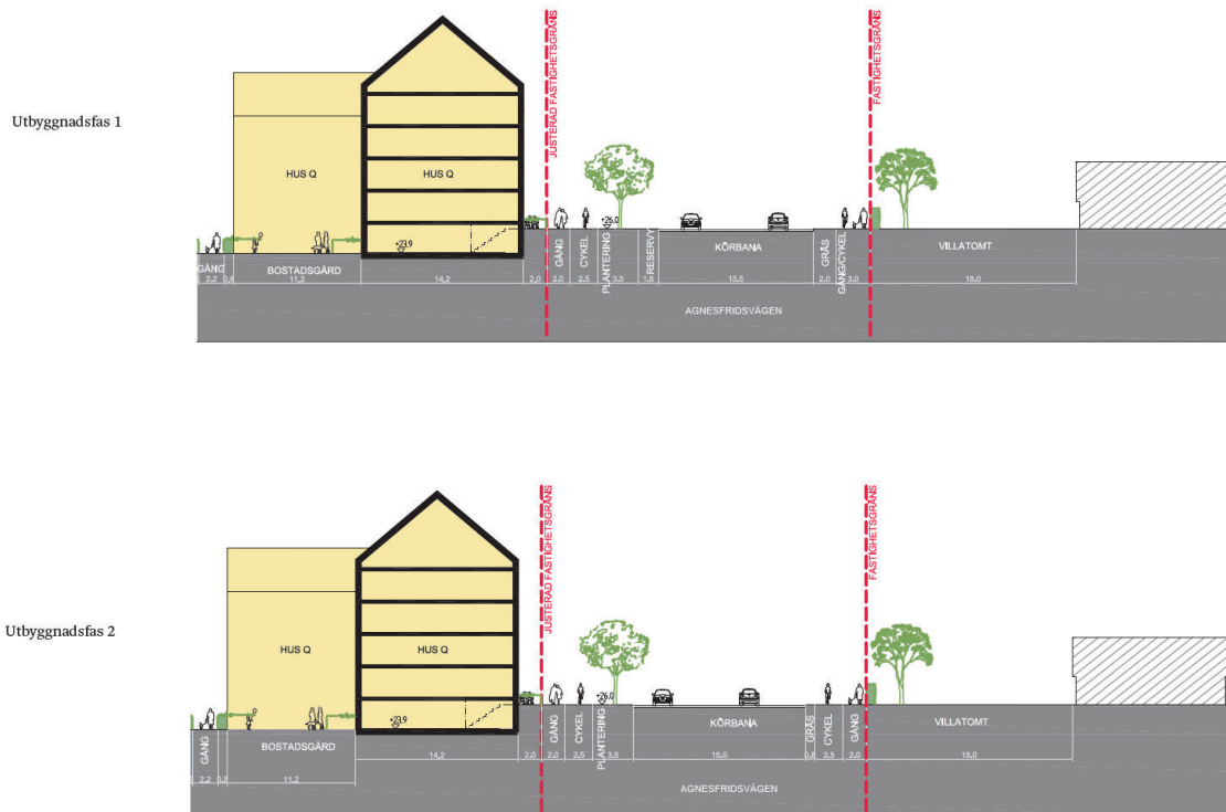
Figur 17. Sektion av Agnesfridsvägen, söder om korsningen vid Derbyvägen efter ombyggnation. Sektionerna visar utbyggnadsfas 1 och 2. I utbyggnadsfas 2 visas en separerad gång och cykelväg. (FOJAB)
