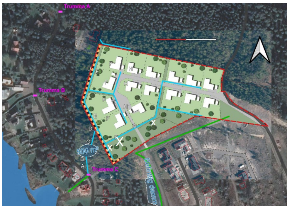
Figur 18. Figur som redovisar en översikt över föreslagen dagvattenlösning med ett västlig magasinläge. Alternativa lägen för ett motsvarande stort magasin inom planområdet redovisas med X eller x för två mindre på två platser.
