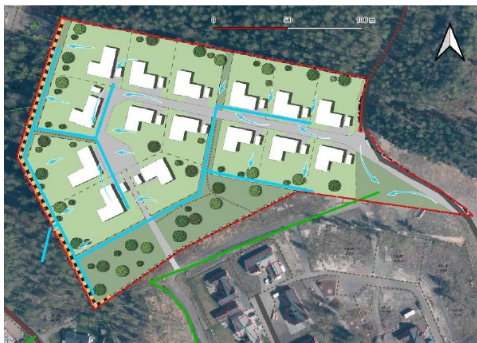
Dagvattenavledning, vid uppfyllnad
