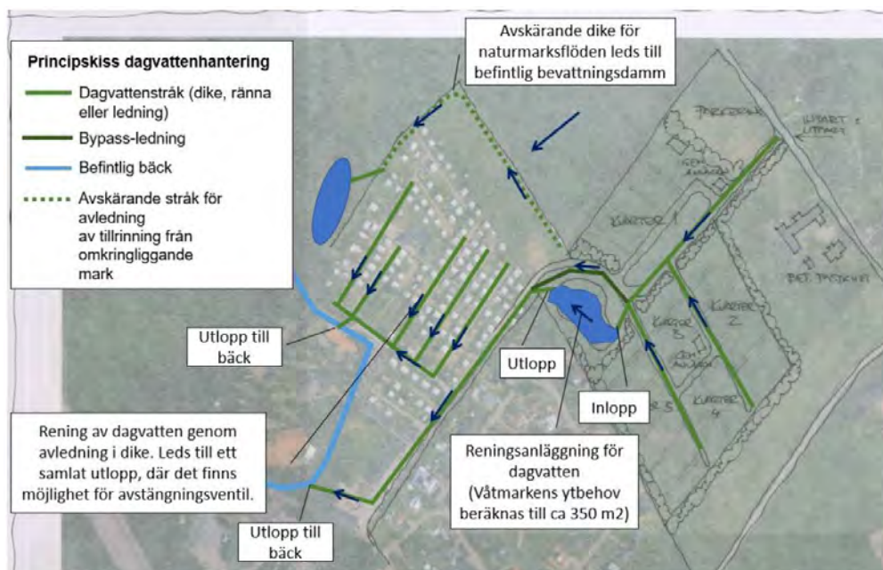
Figur 15 Förslag till dagvattensystem för planområdet (SWECO, 2020)
