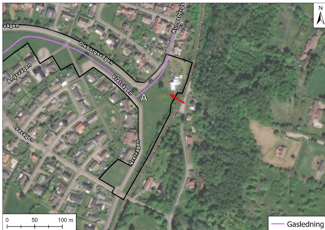
Figur 7. Visar en gasledning som korsar tänkt dragning av dagvattenstråk. Röd pil visar ungefär hur en spillvattenledning passerar banvallen.
