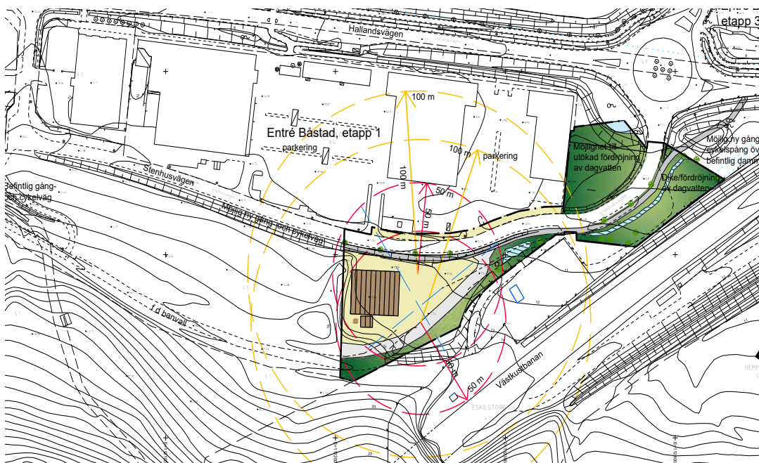
Skiss över föreslagna skyddsavstånd enligt Tyréns rapport, daterad den 8 november 2024. Skyddsavstånd om 50 och 100 meter illustreras med röd respektive gul streckad linje. Blå linje illustrerar 50 meters skyddsavstånd från Trafikverkets teknikkonstruktioner/anläggning.
